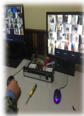
Зураг 34. НЗЗ-ны 4-р байранд 32 сувагтай NVR 2.5tb хард, 3тр нягтралтай камер шинээр суурилуулсан
